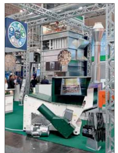
Schuko will, wie bei der letzten „Ligna“ ein breites Angebotsspektrum an Technik und Leistungen vorstellen. Zu den ausgestellten Absaugungen gehört ein mobiler Entstauber als „Zero Emission“-Version der „Vacomat“-Reihe mit einer neuen Generation von Membranfilterschläuchen. Fotos: Schuko
