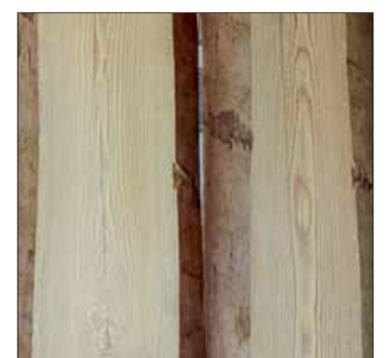
Holz in sieben bzw. zehn Tagen fertig gedämpft und getrocknet
