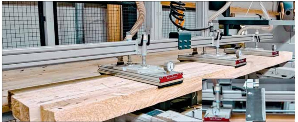
Die Teilautomatisierung im Sägewerk Schnurr ist etwa 15 Mal schneller als die vorherige händische Zuführung zur Kappsäge, entlastet die Mitarbeiter und kommt ohne Schutzzäune aus. Der Flächengreifer „ET-Gripper“ von Eurotech nimmt ganze Lagen auf anstatt wie zuvor die Kappsäge manuell mit nur einzelnen Kanthölzern zu beschicken.
