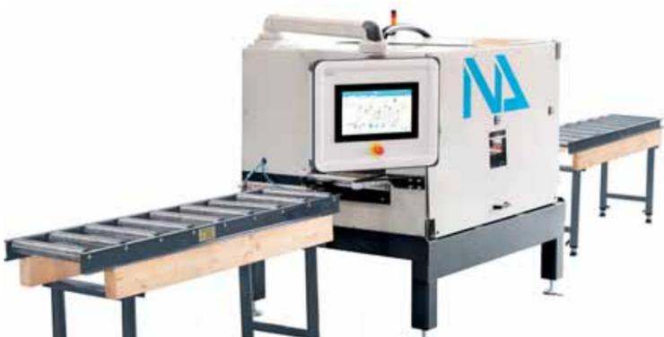
In der „Aela“ werden Äste automatisch erkannt und fixiert. Dazu wird heißer Kleber mit Druck im Ast- und Rissbereich durch die komplette Diele gepresst (Bild oben). Die Aushärtung erfolgt in wenigen Sekunden.
