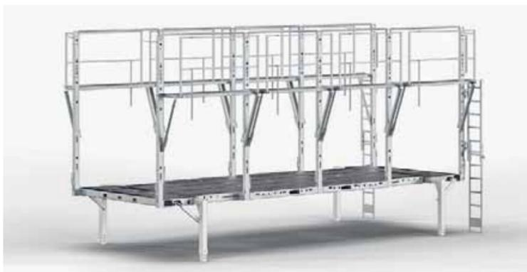
Die Wechselpritsche „XP-BDF“ mit dem neuen Außengerüst – ein steckbarer und seilloser Arbeitssteg ohne Laderaumverlust. Fotos: Auwärter
