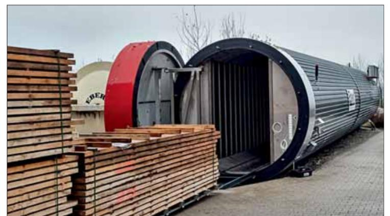
Neuer Dämpftrockner beim Beschicken mit Nadelholz
