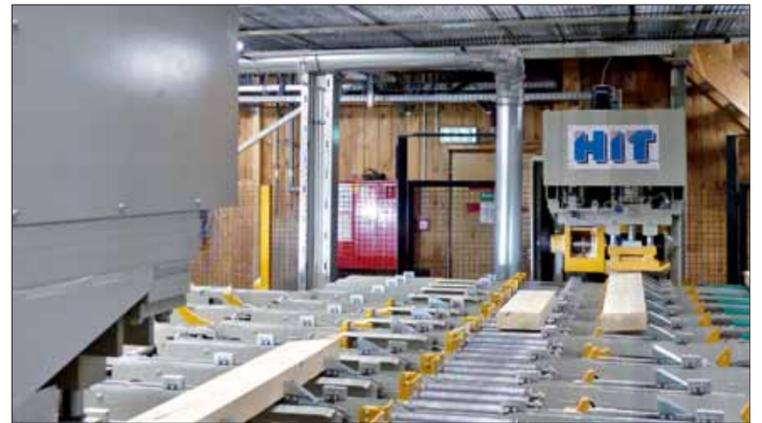
Der Prototyp der „TKZ“-Keilzinkenfräse von HIT Keilzinkentechnik arbeitet seit Mai 2022 im regulären Betrieb bei Merkle Holz in Nersingen. Fotos: J. Härer
