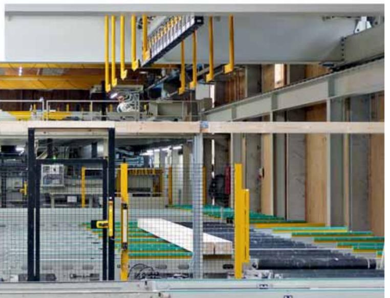
In der Kommissionierung werden die Hölzer aus beiden Produktionslinien zusammengeführt: oben der Kommissioniergreifer, links erhöht die Pufferebene und im Hintergrund auf der oberen Ebene die Reparatur-Station. Im Vordergrund der Querförderer für den Abtransport zur Verpackungsstation.
