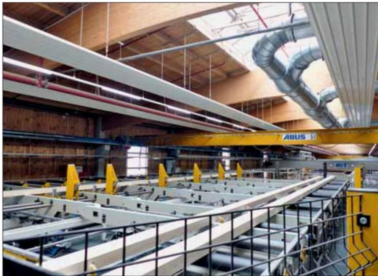
Eine Ebene über den Produktionsanlagen wurde eine vollständig neue Reparatur-Station insatalliert, die über ein Teleskophubgerüst beschickt wird.
