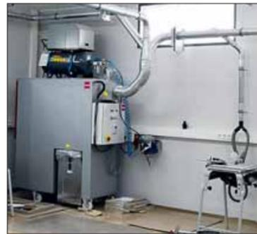
Mitteldruckentstauber sind vor allem zur Absaugung von Handmaschinen geeignet.
