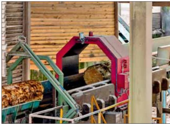
Ein Splittersuchgerät direkt nach der Entrindung (links) und ein zweiter Metalldetektor nach dem Vorschnitt auf der Blockbandsäge gewährleisten bei der IBH Sägewerk GmbH eine zuverlässige Erkennung von Metall im Holz. Fotos: Mesutronic
